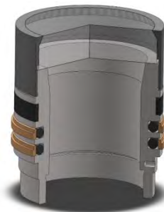
Anelli Bronzo-Teflon per lubrificazione pistone "oil-less"
